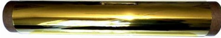
低热膨胀系数聚酰亚胺薄膜是由新型酰单体及新型胺单体的新配方制成的聚酰胺酸树脂，经双向拉伸工艺生产的新型亚胺薄膜，它不仅具有普通聚酰胺酸薄膜的所有优异性能，且具有更高的尺寸稳定性、高弹性模量及低热膨胀系数。
